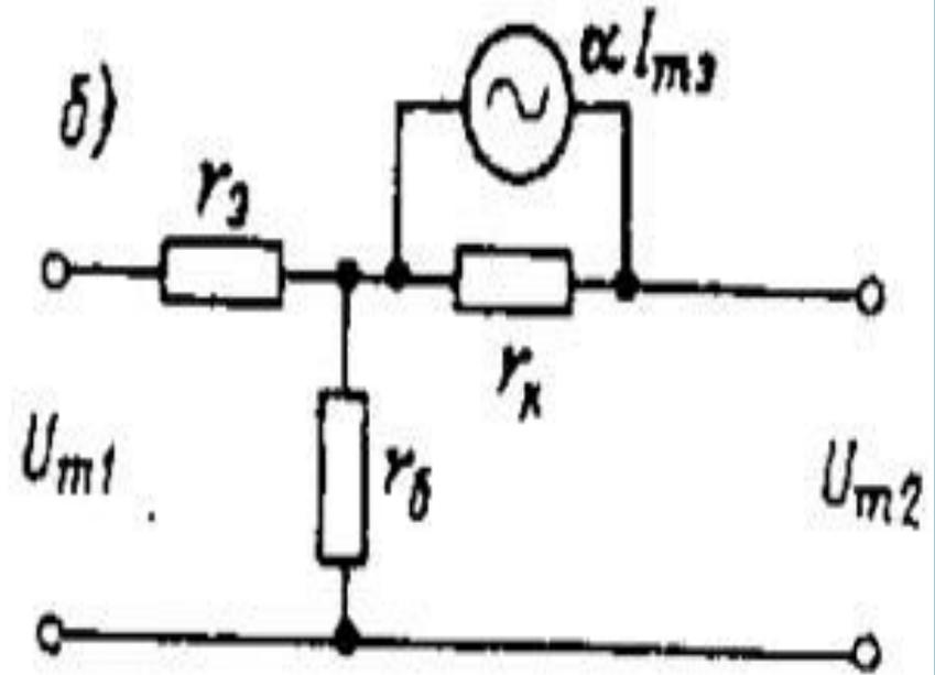
Эквивалентная T-образная схема транзистора с генератором тока
