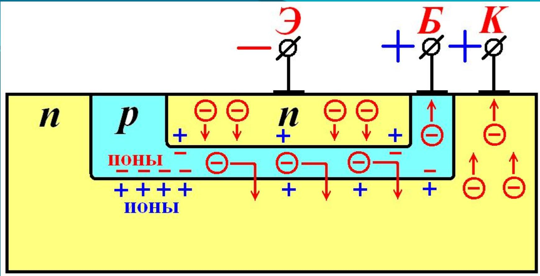
База вызывает электроны из эмиттера, но переход эмиттер – коллектор для них открыт (здесь они не основные заряды) и большая часть уходит в коллектор, совсем немного доходит до базы. За счет этого происходит усиление базового тока (ток коллектора).
