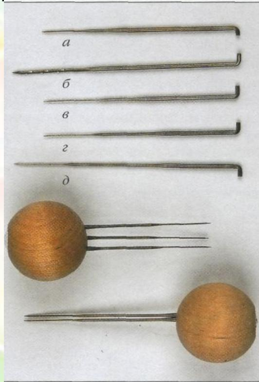
Иглы для валяния сделаны из закаленной стали, обладают достаточной упругостью. Длина игл от 8-10 см. Один конец иглы для валяния загнут под прямым углом, чтобы было удобно держать, а на другом сделаны насечки. При втыкании иглы в шерсть насечки зацепляют волокна и протаскивают их в нижние слои, таким образом, происходит спутывание, то есть валяние. Иглы для валяния имеют номера: чем больше номер, тем тоньше игла.
