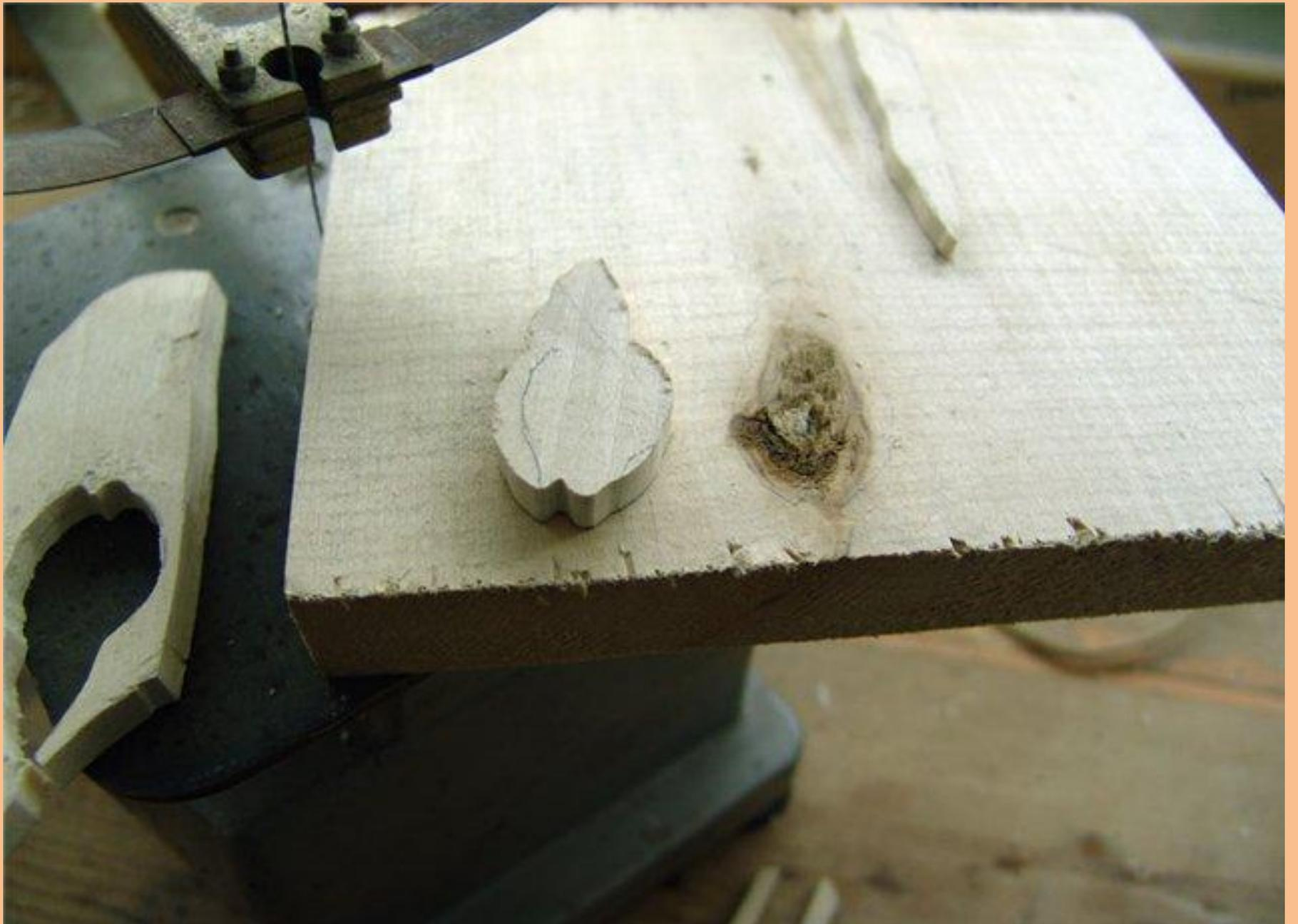
**В отверстия, остающиеся после выпавших сучков, при необходимости вставляют деревянные пробки (на клею или без него). Иногда специально высверливают сучки, а отверстия также заделывают пробками. Однако прочность древесины при этом не повышается, так как искривления волокон вокруг пробок по-прежнему остаются.**
