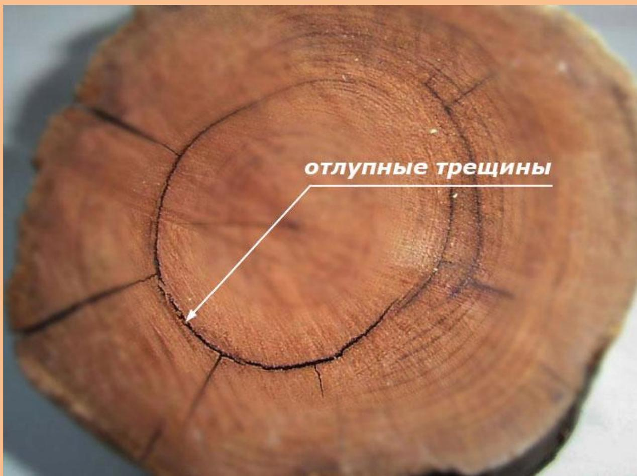
**Трещины усушки** появляются в лесоматериалах под действием сушильных напряжений. Трещины распространяются от боковой поверхности в глубь ствола.
