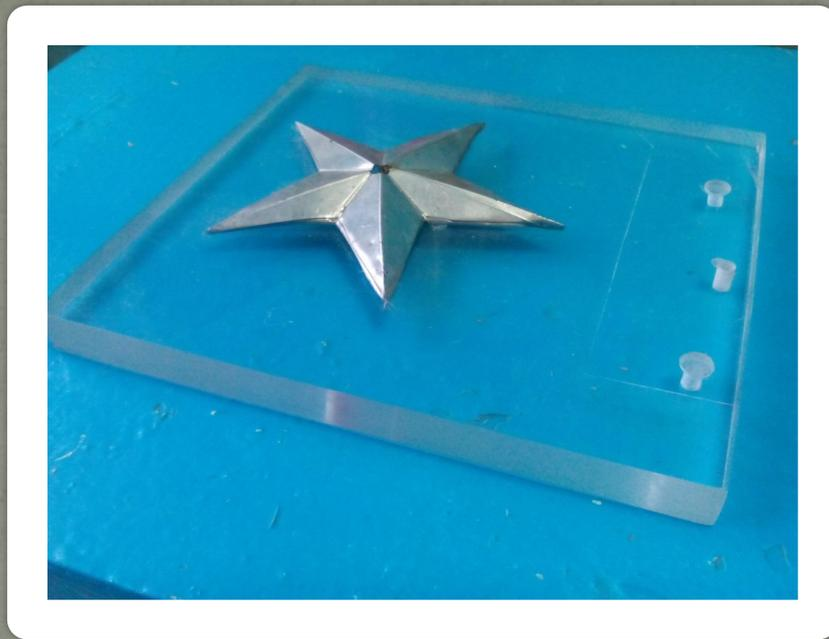
Изготовление символ ЗВЕЗДА из листового материала – нержавеющей стали. Размеры  $\varnothing$  100 x 0,5
