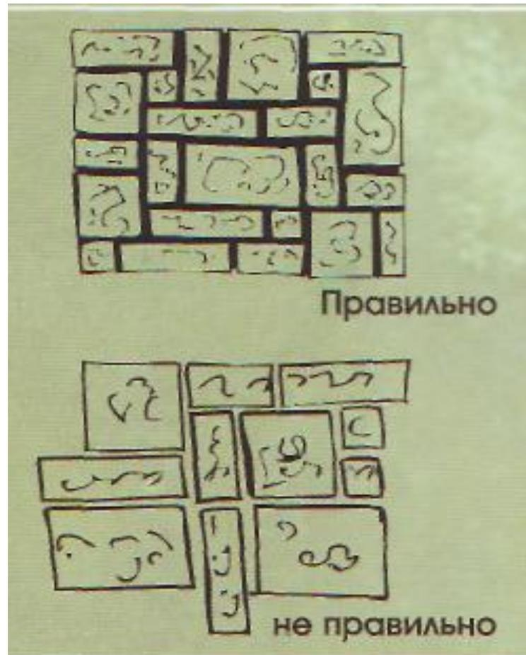
После того как камень уложен на стену, необходимо провести расшивку швов. Приобретите расшивку, предназначенную для работы с натуральным и искусственным камнем и допускающей ширину шва до 20 мм
