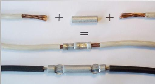
Опрессовка – это соединение проводов, когда скрутка опрессовывается специальной алюминиевой или медной гильзой. Ее внутренний диаметр соответствует диаметру скрутки.
