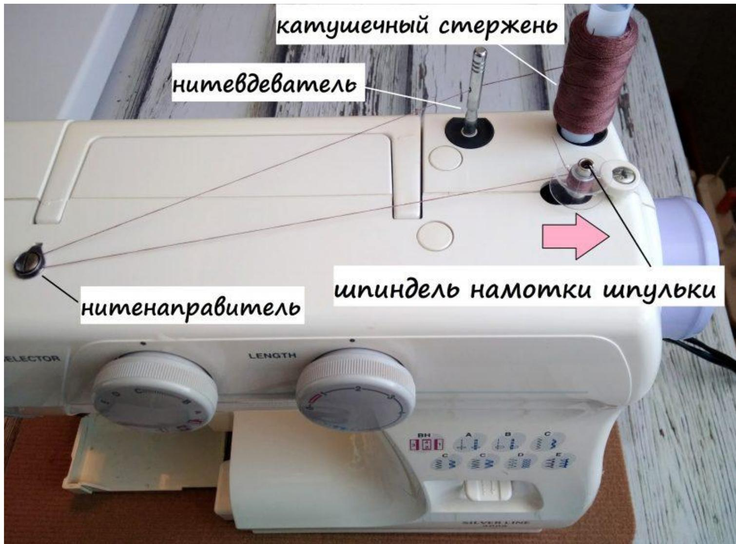
После того как я зафиксирован нить на шпульном колпачке, устанавливаем колпачок на шпиндель намотки и отводим его по направлению к маховому колесу. Теперь можно включить швейную машинку, нажать на педаль и на шпульку начнет наматываться нить.
