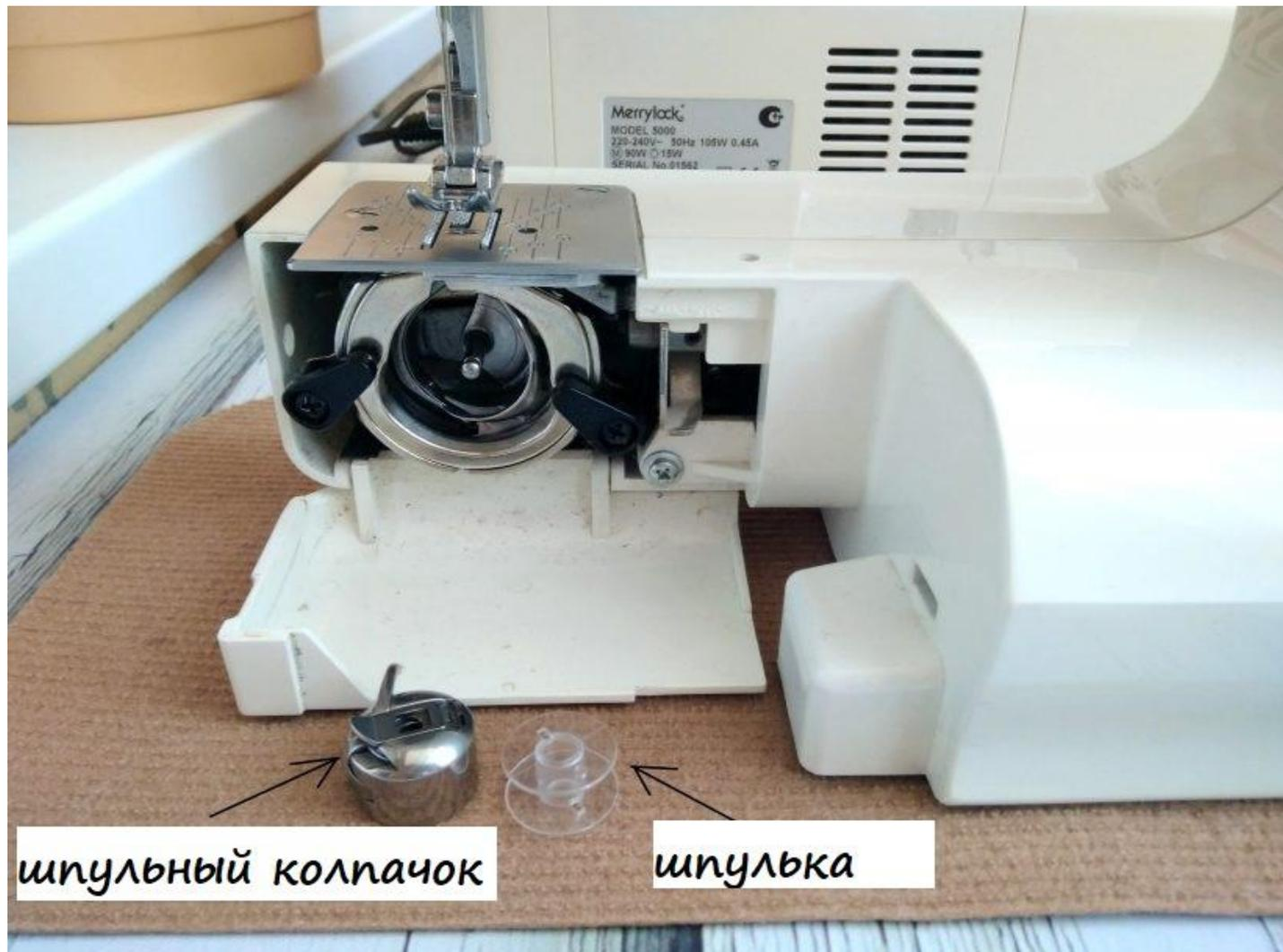
Вынимаем из швейной машинки шпульный колпачок со вставленной в него шпулькой. Ваша швейная машинка может быть с горизонтальным челноком, но в обоих видах машин, место для нижней заправки нити имеет шпульный колпачок и шпульку. Так что большой разницы, как заправлять нить в швейную машинку с горизонтальным или вертикальным челноком, тут нет.
