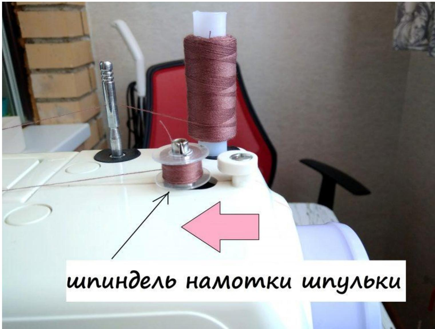
После того как намотан необходимое количество, останавливаем маховое колесо. Перемещать шпиндель по направлению от махового колеса, (обрезать нить, снимать шпульку со шпинделя)
