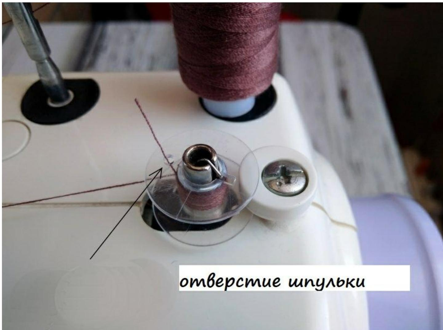
Устанавливаем нитку на катушечный стержень, проводим нитку через нитенаправитель, продеваем конец нити через отверстие шпульки и наматываем нитку пока вручную, сделав три четыре оборота.
