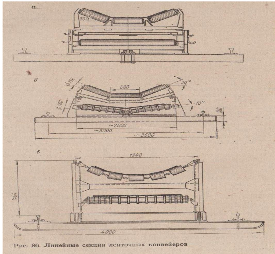
Рис. 86. Линейные секции ленточных конвейеров
