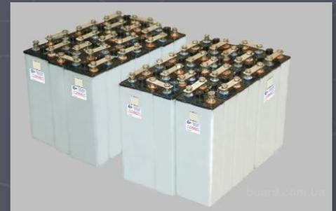
При заряде аккумулятора под действием электрической энергии, подводимой от внешнего источника тока, происходит окисление активной массы положительных пластин, сопровождаемое переходом гидрата закиси никеля  $\text{Ni(OH)}_2$  в гидрат окиси никеля  $\text{Ni(OH)}_3$ . В то же время активная масса отрицательных пластин восстанавливается с образованием губчатого железа Fe или губчатого кадмия Cd.
