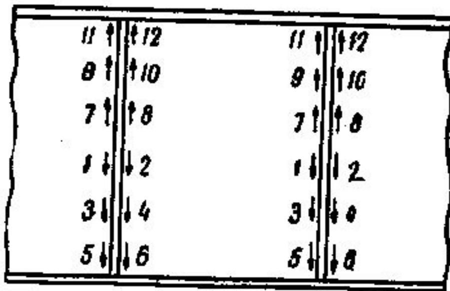
Способ приварки ребер жесткости к вертикальной стенке балки
