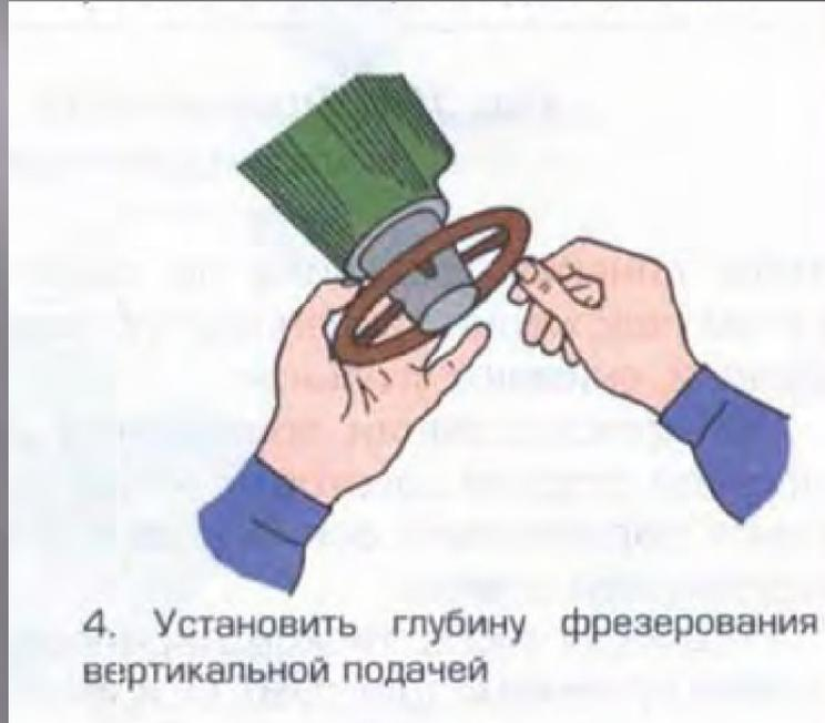
4. Установить глубину фрезерования вертикальной подачей
