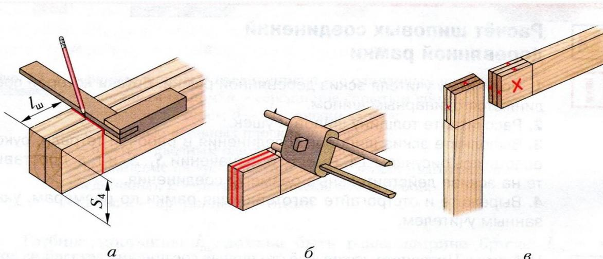
Затем пилой с мелкими зубьями выпиливают отмеченные куски древесины на обоих брусках. При этом пропилы должны размещаться внутри проушины и снаружи шипа, а линии разметки оставаться нетронутыми у края пропила.
