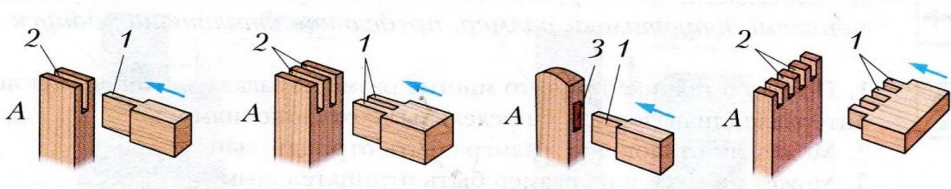
Количество шипов в соединении зависит от толщины брусков. Если толщина соединяемых брусков до 40 мм, применяют одинарные шипы (см. рис. а) у если от 40 до 80 мм — двойные (см. рис. б), а если свыше 80 мм — тройные. Для соединения досок (например, при изготовлении ящиков) количество шипов может быть достаточно большим (см. рис. г).
