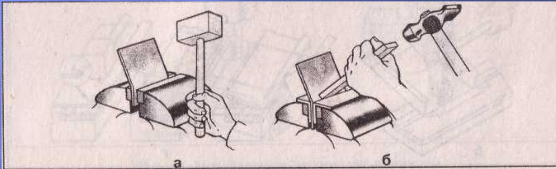
Рис. 62. Сгибание заготовок из тонколистового металла в тисках:
