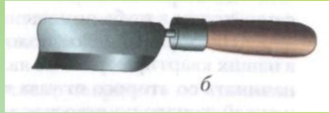
б — нож для разрезки трещин
