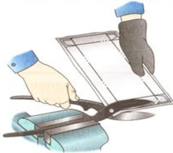
Удобнее и легче резать заготовку, если одну ручку ножниц закрепить **в тисках**
