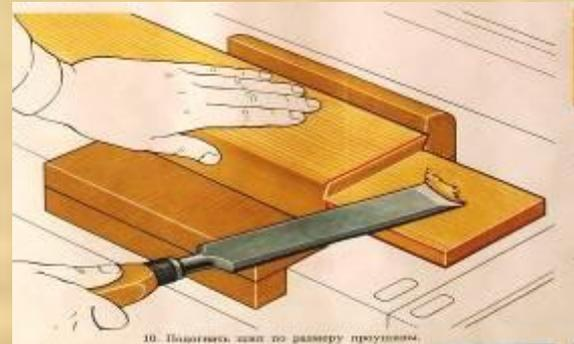
Очень часто ученики допускают неточности и ошибки при выполнении запиливания шипов и проушин. Необходимо внимательно следить - где должно проходить полотно пилы при запиливании.
