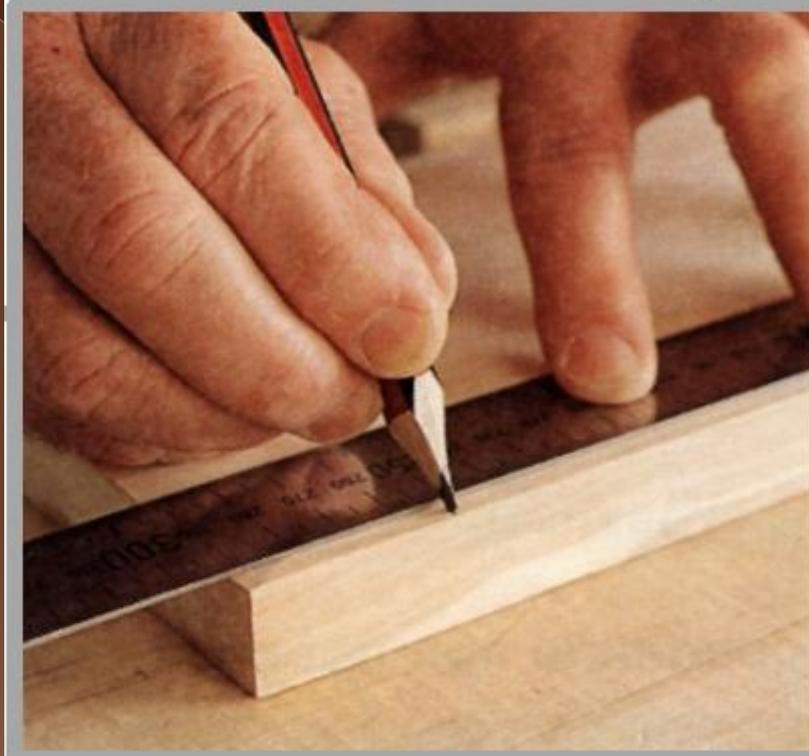
Избыточный слой заготовки (сверх чертежного размера детали), подлежащий удалению при последующей обработке режущим инструментом называется **припуском**.
