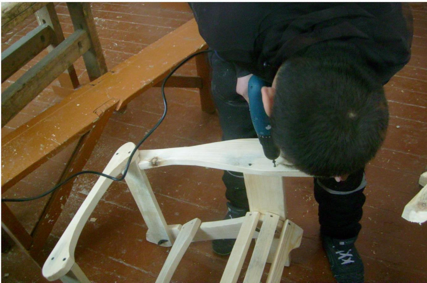
Крепления с помощью шурупов.
