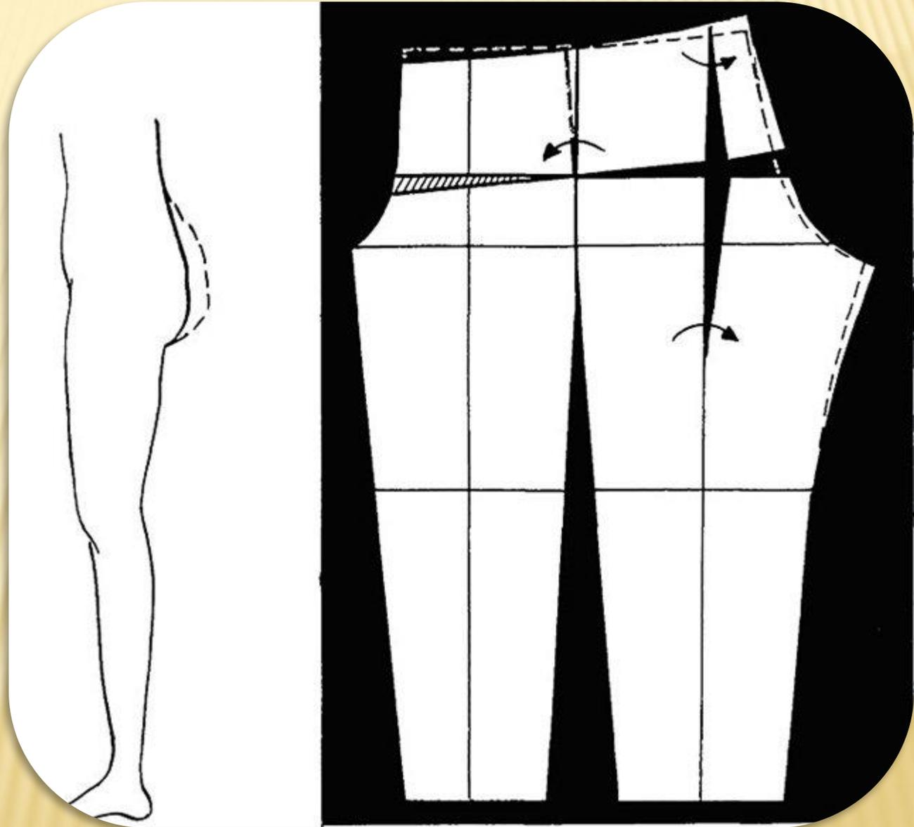
Корректировка чертежа конструкции брюк на фигуру с выступающим животом.
