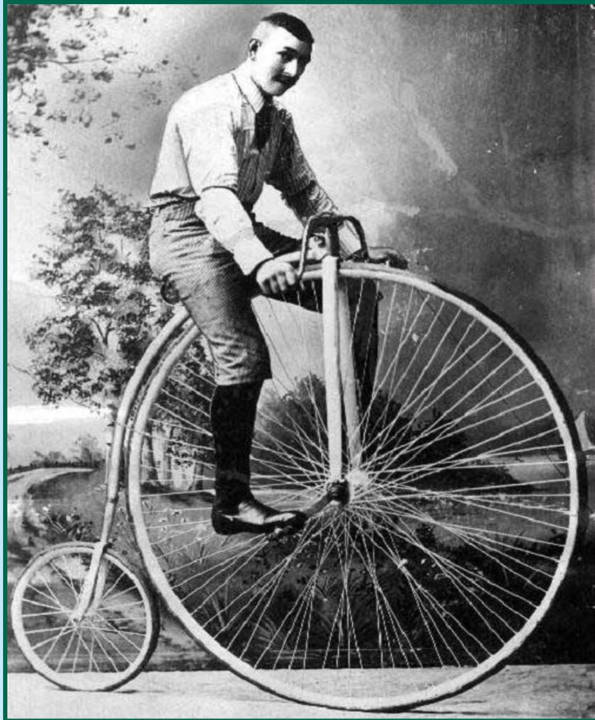
Поскольку педали велосипеда были присоединены непосредственно с передним колесом, от езды требовалось очень быстро крутить их, чтобы набрать скорость. Эту проблему преодолел в 1870 г. производитель швейных машинок из Ковентри который сообразил: если переднее колесо будет иметь больший размер, с каждым поворотом педалей велосипед сможет
