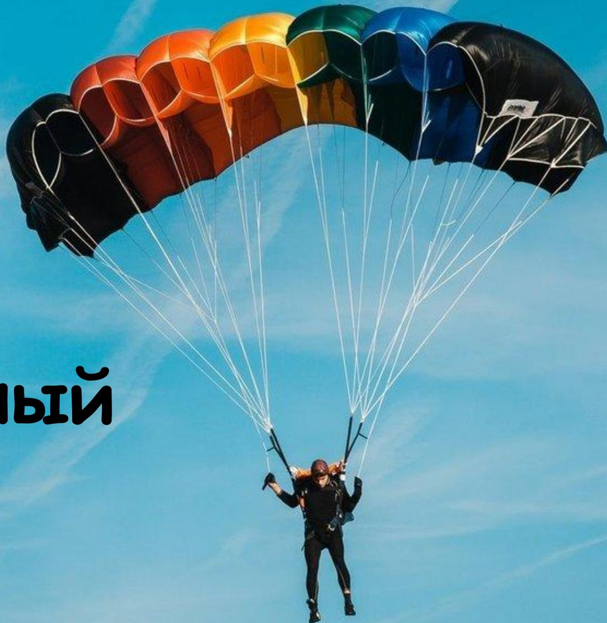
Парашют — от французского parachute (от греческого para — «против» и французского chute — «падать») — устройство для торможения объекта за счет сопротивления атмосферы. Используется для безопасного спуска с высоты людей, грузов, космических аппаратов, уменьшения пробега при посадке самолетов и других целей.
