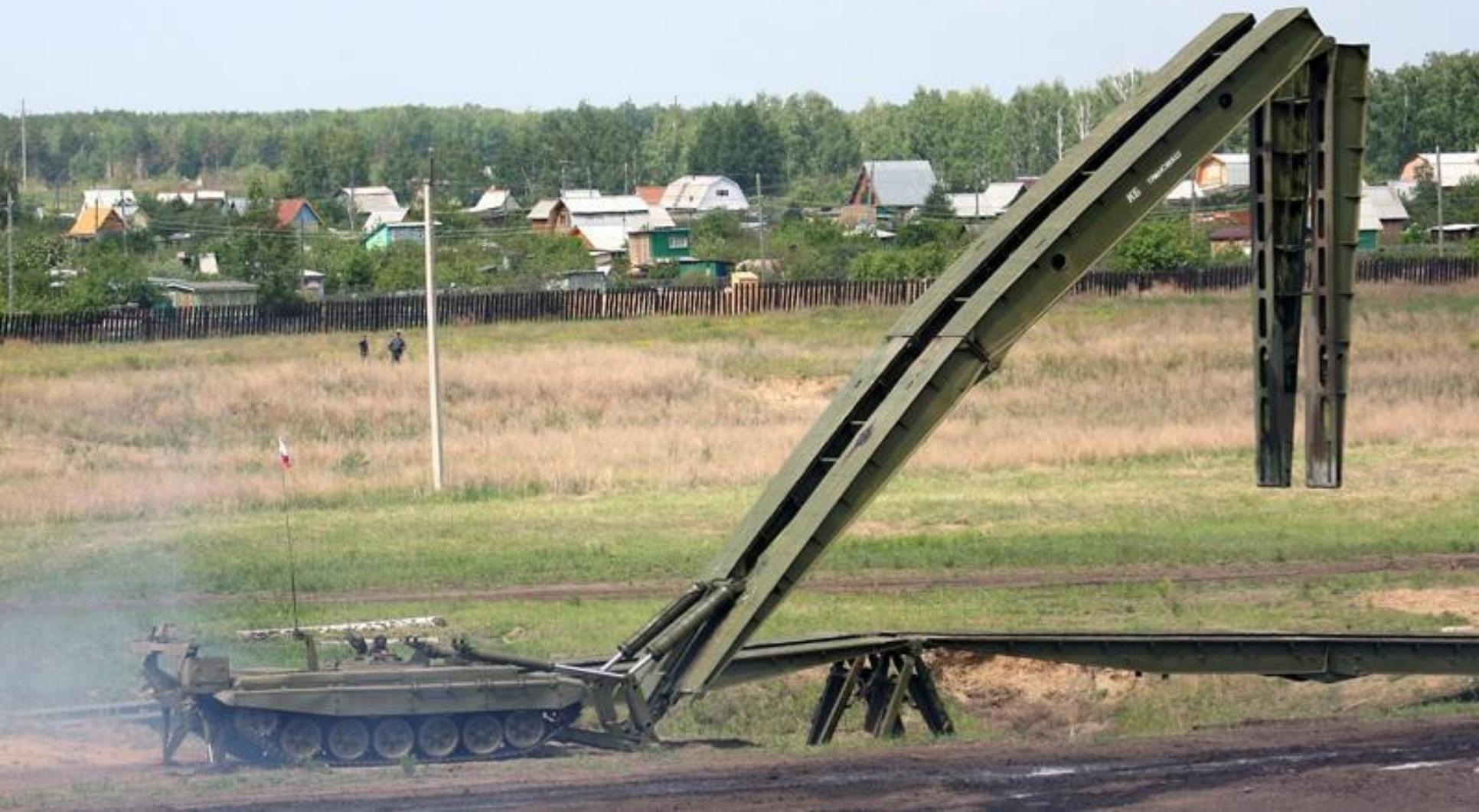
Танковый мостовкладчик МТУ-90 во время укладки моста.
