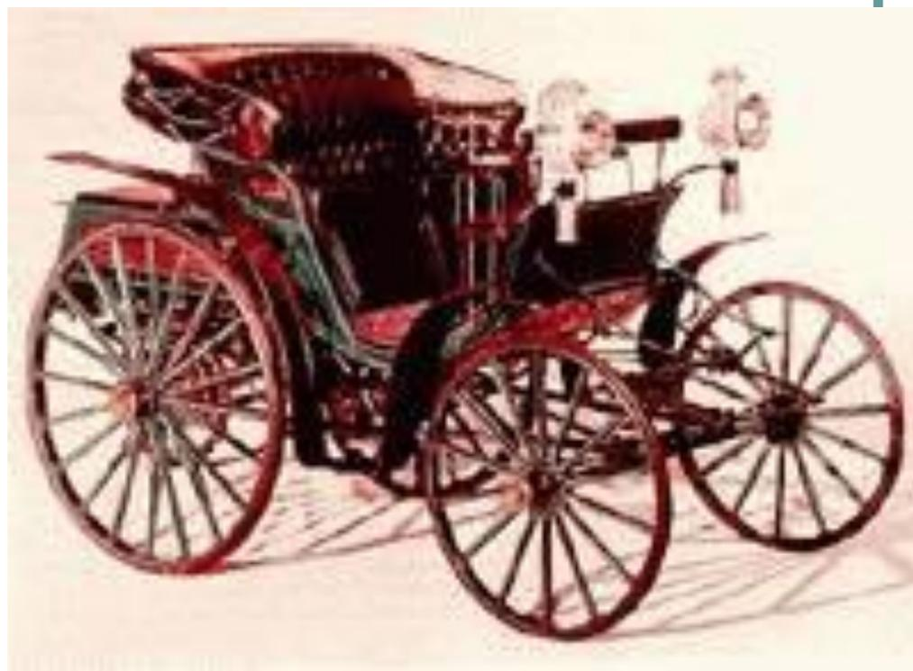
Одна из самых известных моделей Эттори Бугатти — "Vebe Peugeot". На ней устанавливался небольшого размера четырехцилиндровый двигатель рабочим объемом 850 куб. см и мощностью 10 л.с. Большинство автомобилей имело закрытый кузов; на фото — один из немногих с открытым кузовом. За период с 1913 по 1916 год их выпустили более трех тысяч.
