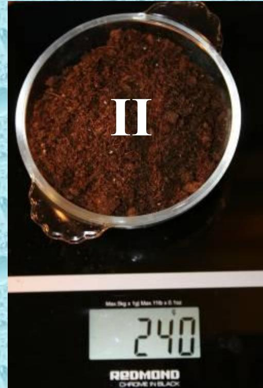
Отмерим одинаковое количество торфа каждого образца и подпишем их. Нагреем духовку до 60 градусов и поставим формы с торфом на 6 часов, для того, чтобы вода, содержащаяся в торфе, полностью испарилась.
