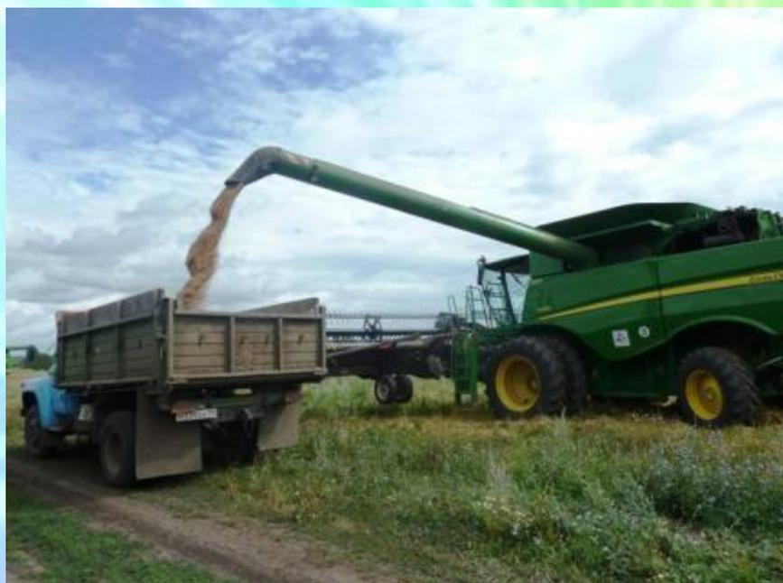
**Чтобы скосить хлебные нивы — нужны комбайны. Комбайн – замечательная машина, которая выполняет несколько работ, ею надо только умело управлять. Комбайн и жнёт (*срезает*) колос и собирает их, очищает и сыпает чистое зерно в грузовые машины.**
