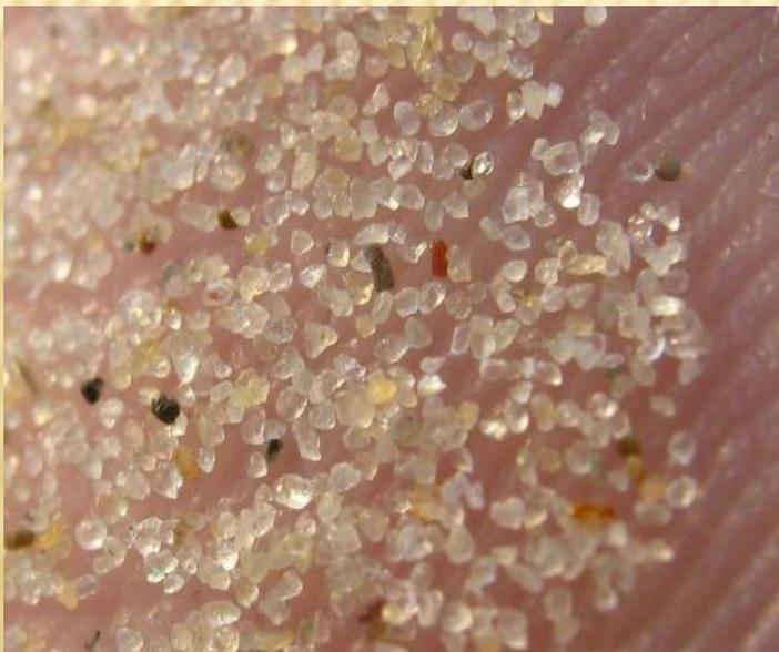
**Речной песок**-это строительный песок, добытый из русла рек, отличающийся высокой степенью очистки и отсутствием посторонних включений, глинистых примесей и мелких камней.
