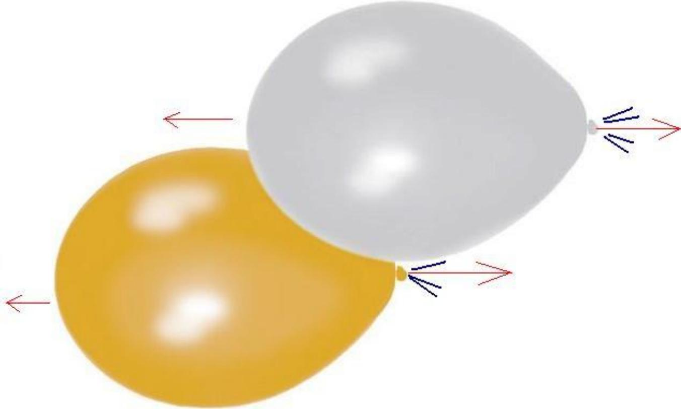
Вы можете продемонстрировать ребенку реактивное движение следующим образом. Надуйте обычный воздушный шарик и, не завязывая его, отпустите. Воздух, вырываясь из шарика, вызовет его движение в противоположном направлении
