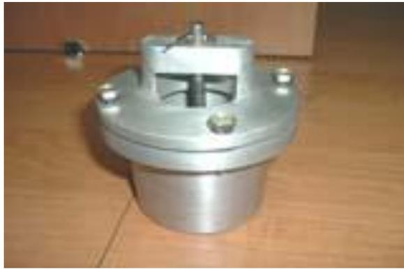
Клапан специально настроен для герметичного перекрытия обратного потока. С помощью рычага управления затвор устанавливается в закрытом положении, что обеспечивает гарантированную защиту от обратного потока. При этом при движении потока в нормальном направлении клапан легко открывается и пропускает поток.
