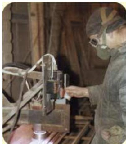
Нанесение латунного ЭМП на бойлерные трубки
