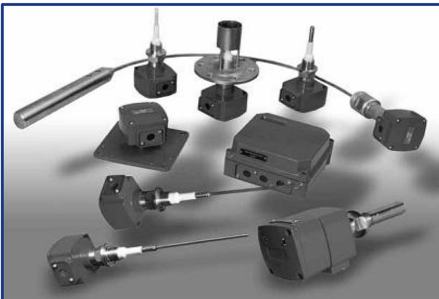
Принцип действия датчиков реле основан на высокочастотном методе преобразования изменения электрической емкости чувствительного элемента, вызванного изменением уровня контролируемой среды в "релейный" выходной сигнал
