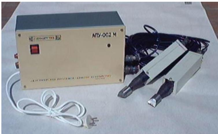
АПУ "ЭКОАКУСТИК" включает в себя генератор электрических колебаний и соединенные с ним кабелями электроакустические преобразователи, жестко закрепляемые с помощью приваренных на выбранных местах теплообменного агрегата резьбовых втулок. Режим работы устройства радиоимпульсный.
