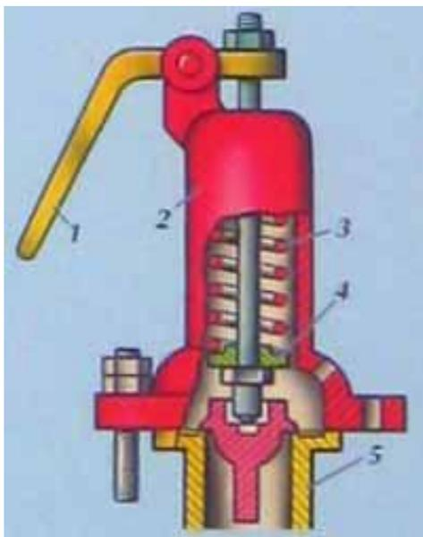
1. Рычаг для опробования
