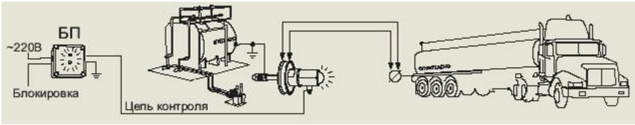
Применяется во взрывоопасных зонах для заземления автоцистерн с целью отвода зарядов статического электричества при сливе-наливе воспламеняющихся жидкостей. Устройства осуществляют постоянный контроль сопротивления цепи контура заземления автоцистерны и подачу светового сигнала при наличии заземления. Устройство УЗА на ТС ГТС устанавливается на пункте слива-налива и выполняют также функцию автоматической блокировки исполнительных механизмов слива-налива при нарушении заземления автоцистерны
