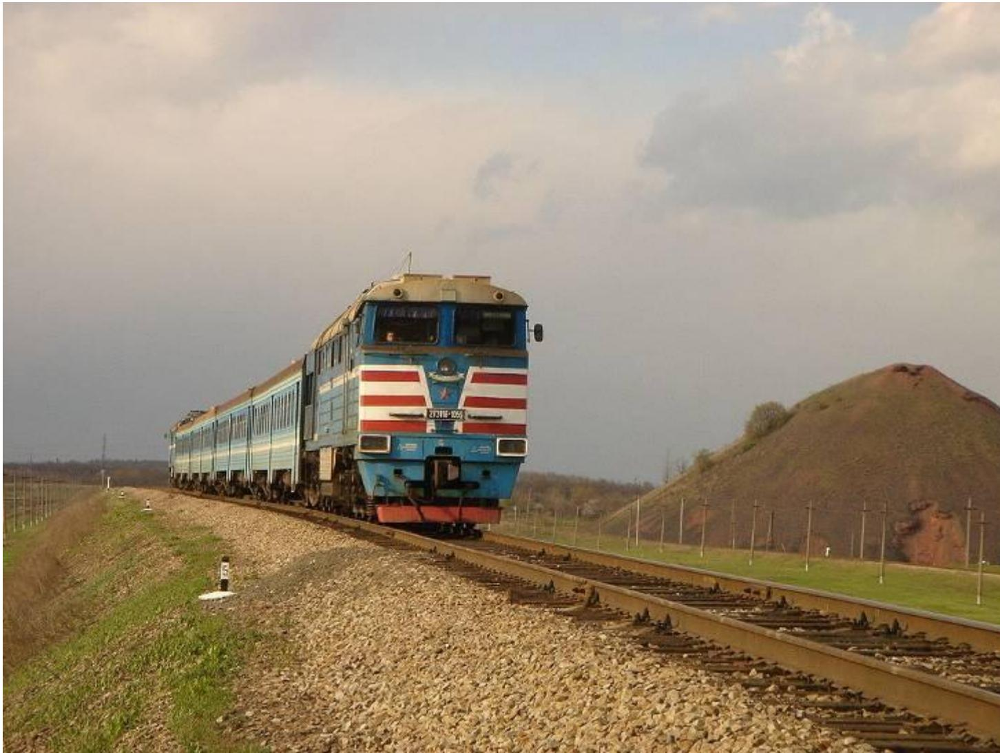
Потом появились тепловозы. Еще их называют дизелями. У них мотор такой же, как у маминой машины, только больше, и вместо бензина их заправляют дизельным топливом. Они могут доехать даже туда, где нет электричества. Но ходят такие поезда довольно медленно.
