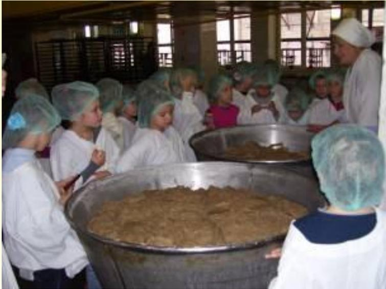
По трубам, идущим с потолка, движется мучной поток и попадает в округлые металлические чаши, куда также подается все, что нужно для получения , соль, сахар. Специальная машина перемешивает содержимое чаши до получения однородной массы. Затем тесту нужно дать постоять, тогда оно созреет, станет пышным и воздушным.
