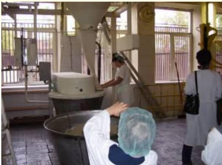
**Готовое тесто из чаши опрокидывают в бункер, похожий на блестящую воронку, а оттуда в тесторазделочную машину.**
