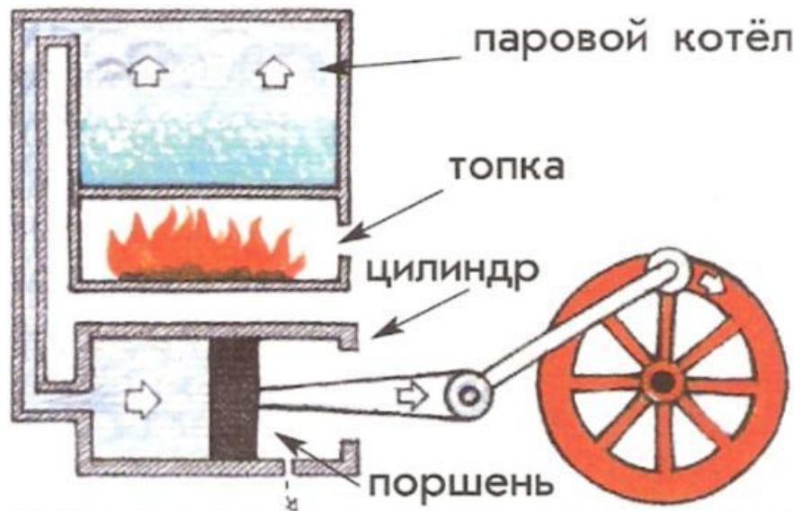
В паровом двигателе пар давит на поршень и вращает колесо.
