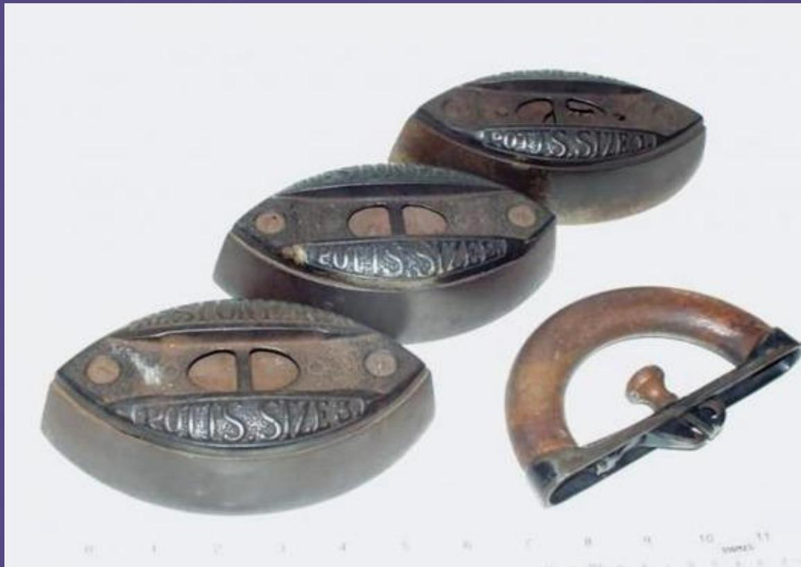
**Со временем стали пользоваться двумя утюгами: пока один нагревался на печке, другим гладили. Это самые простые утюги - нагревательные. Перед употреблением чугунные монолиты разогревали в печи. Утюги для ткани весили по разному- от одного до 10 килограммов.**
