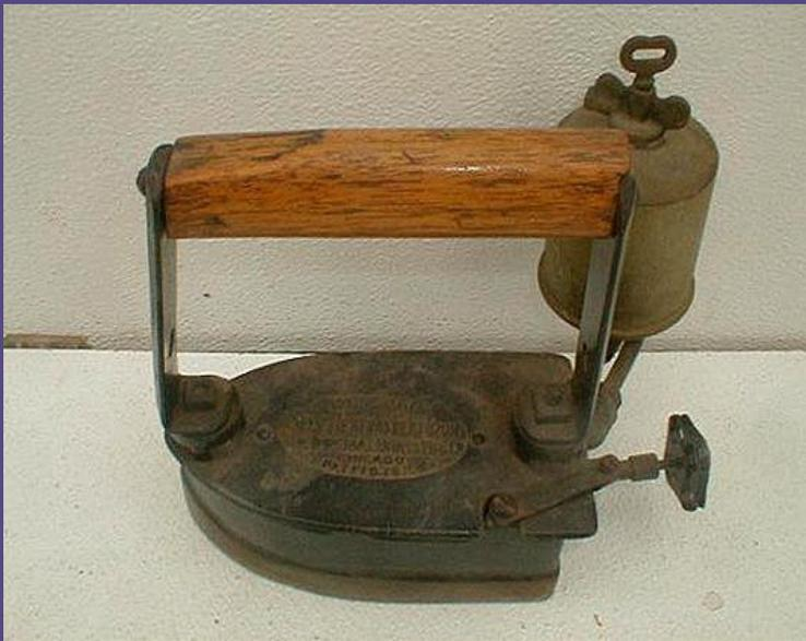
В конце XIX века стали производить газовые утюги. Принцип их работы был тот же, что и у газовых плит: утюг разогревался от горящего газа. В корпус такого утюга была вставлена металлическая трубка, подсоединенная другим концом к газовому баллону, а на крышке утюга располагался насос.
