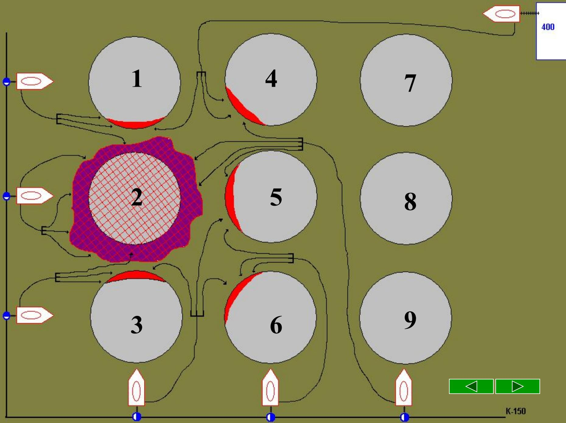
12. Определяем количество ГПС-600 для тушения разлившегося нефтепродукта.
