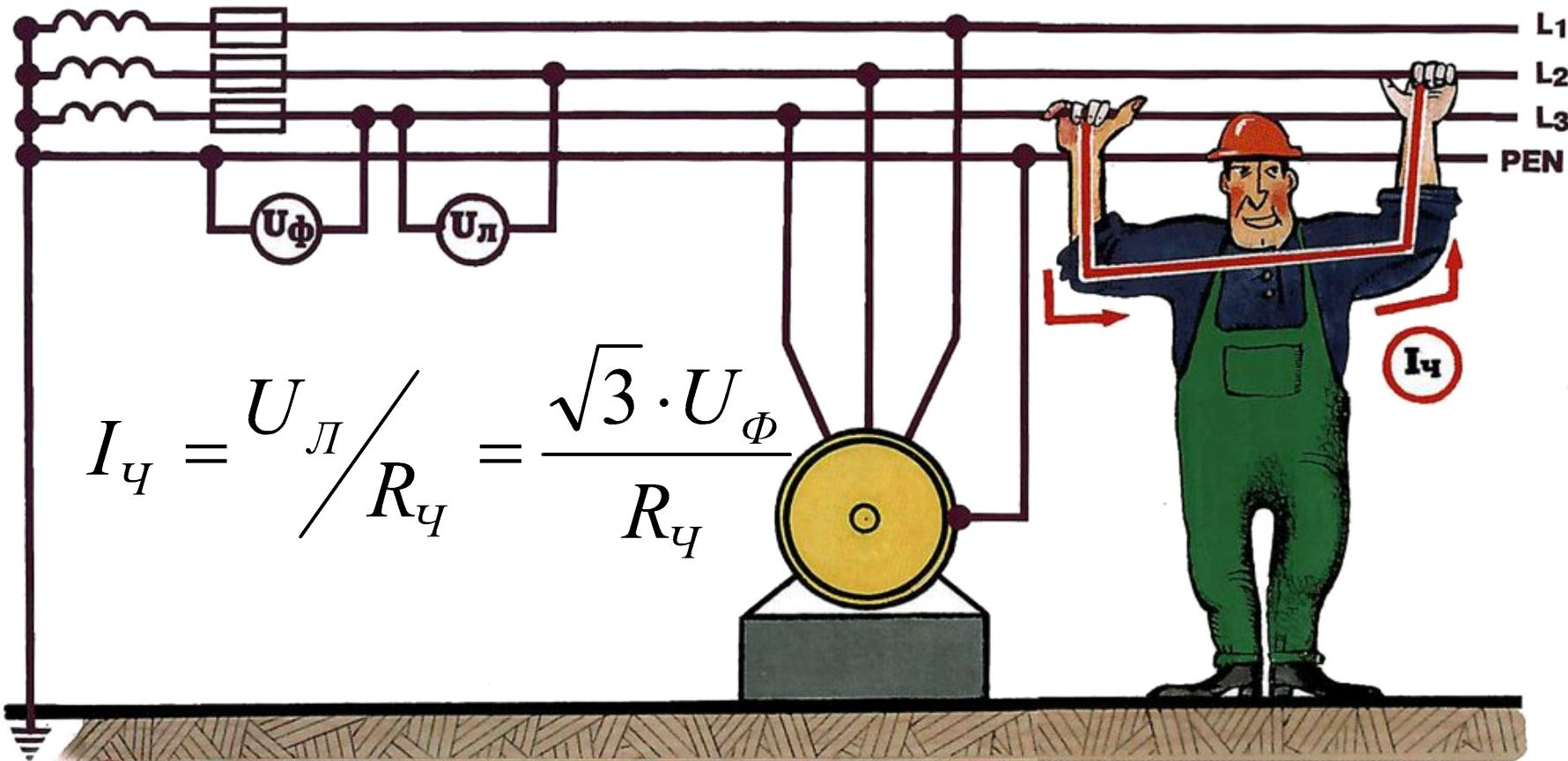
$U_L$  и  $U_\Phi$  – линейное и фазное напряжение;
