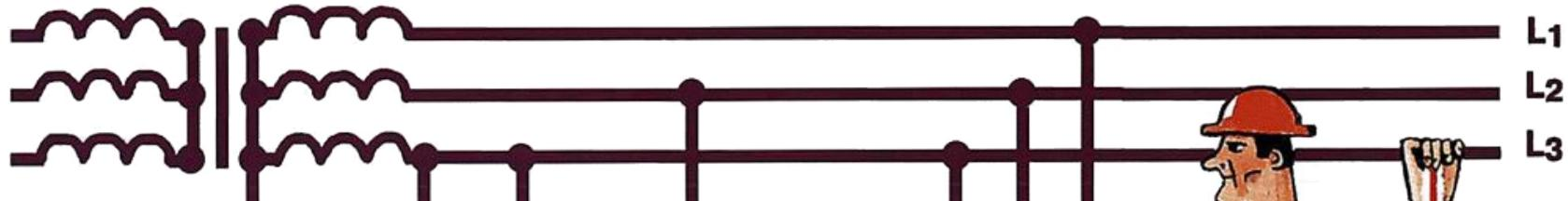
$$I_Q = \frac{U_\Phi}{R_Q + R_{OB} + R_P + \frac{R_{IZ}}{3}}$$
