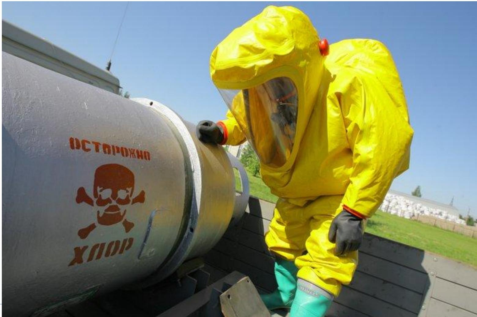
В сжиженном состоянии хлор может находиться только при избыточном давлении или при температуре ниже минус 34 °С. Хранится и транспортируется жидкий хлор в сосудах, выдерживающих избыточное давление
