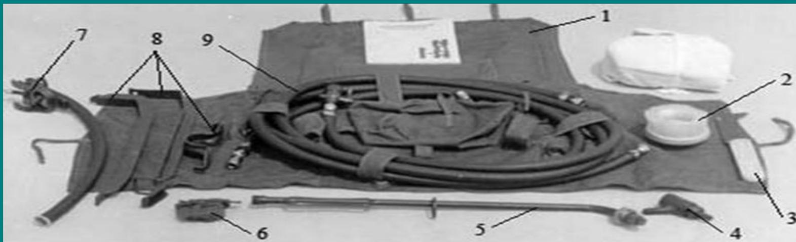
Комплект для специальной обработки автотракторной техники ИДК-1:
