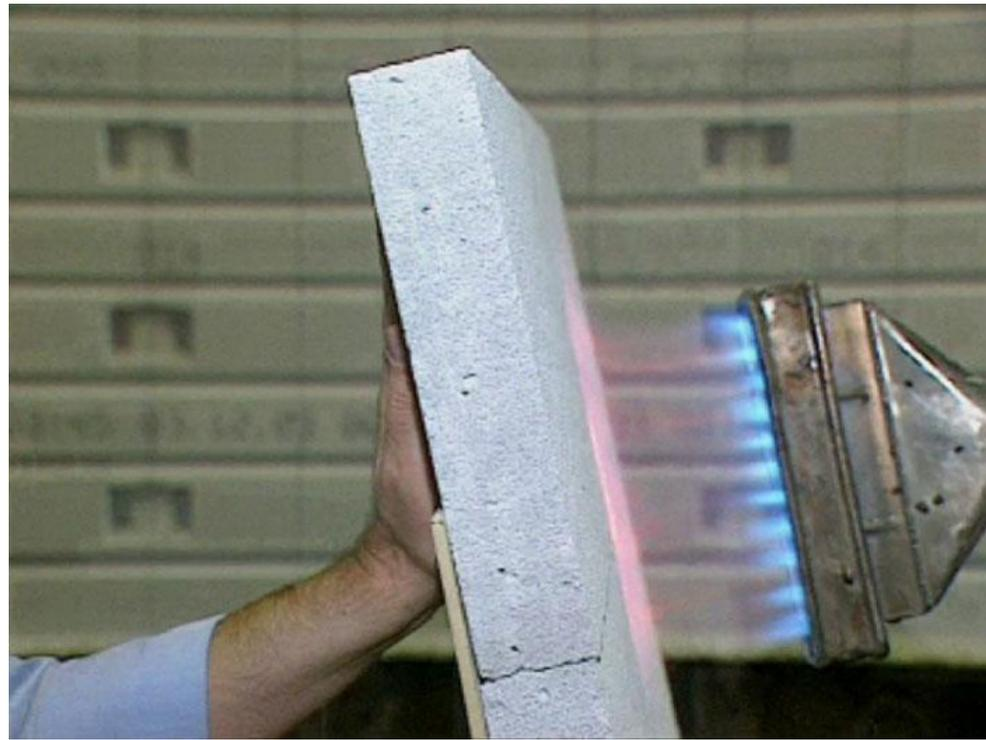
физических свойств материалов. Например, каменные стены здания толщиной 120 мм имеют предел огнестойкости 2,5 ч, а при толщине 250 мм предел огнестойкости повышается до 5,5 ч.
