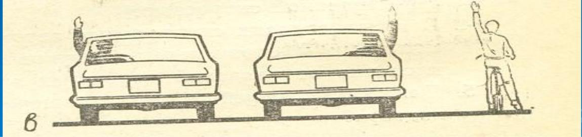
а- сигнал поворота налево; б- сигнал поворота направо; в- сигнал торможения.
