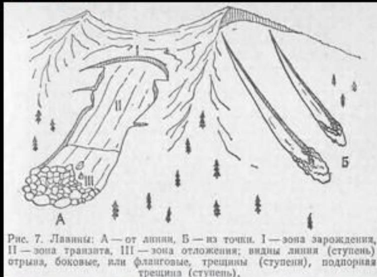
Рис. 7. Лавины: А — от линии, Б — из точки. I — зона зарождения, II — зона транзита, III — зона отложения; видны линия (ступень) отрипа, боковые, или фланговые, трещины (ступени), подпорная трещина (ступень).
