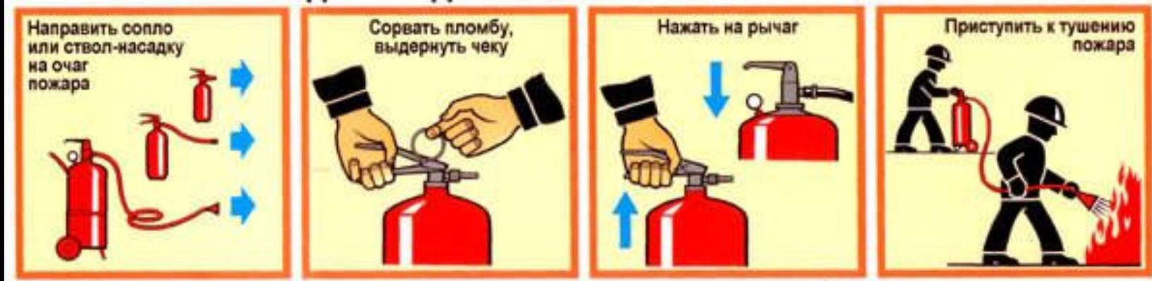
Этими огнетушителями можно тушить небольшие возгорания электроприборов, горючих газов и жидкостей.
