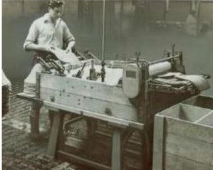
В середине 19, начале 20 веков изобрели валяльные прессы, и валяльные машины. Валка происходила посредством сдавливания и прокатывания шерсти или при механическом воздействии специальных иголок, которые спутывали шерстяные волокна
