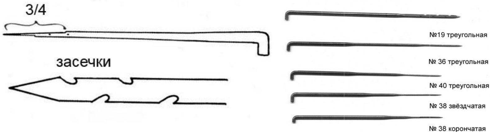
**Сухое валяние** – уплотнение комочков шерсти с помощью специальных игл. Иглы снабжены насечками, именно с их помощью происходит сцепление и спутывание волокон. Зазубрины на иглах направлены в противоположную сторону, поэтому игла легко выпутывается из шерсти.
