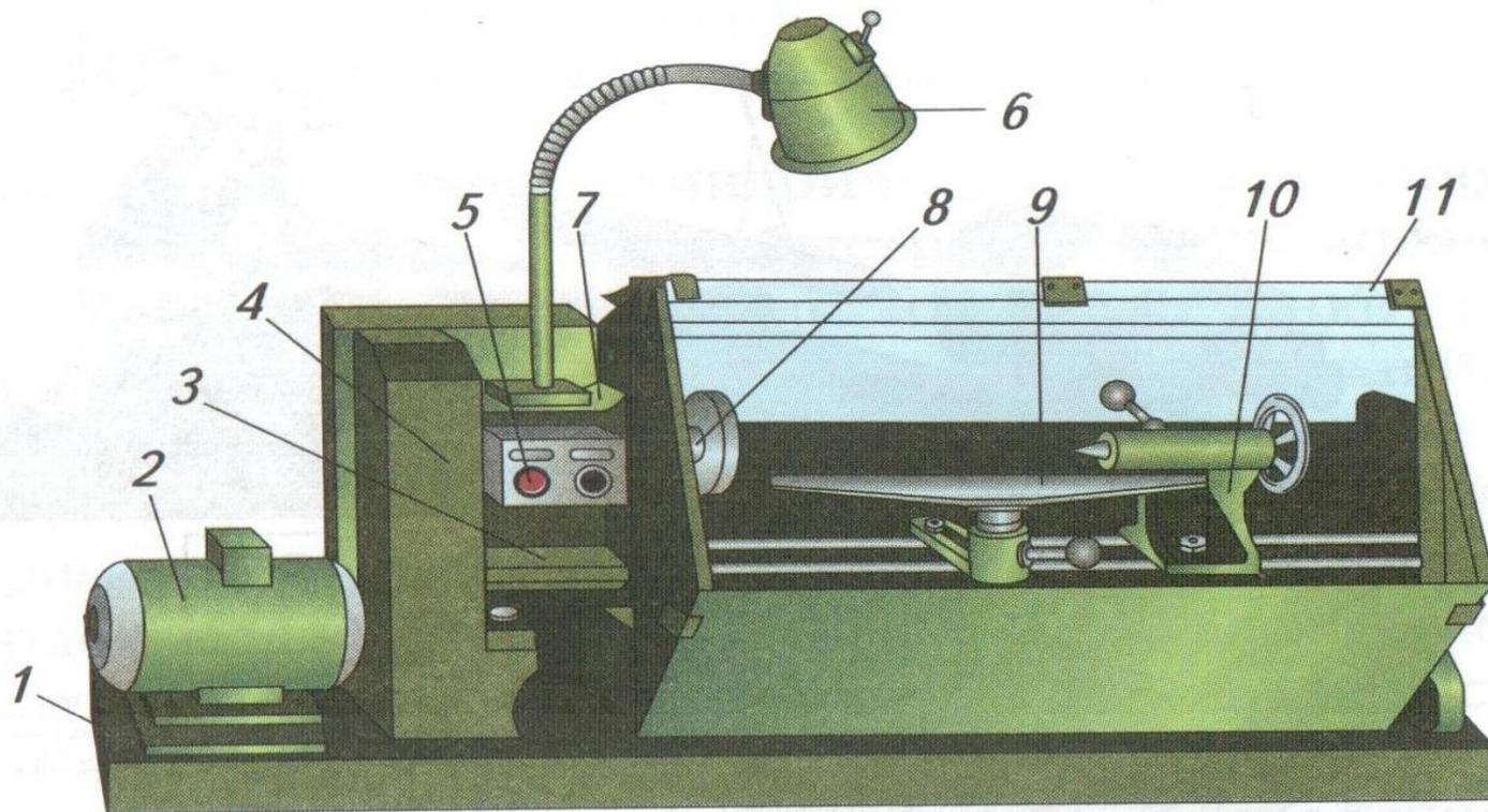
Токарный станок для точения древесины СТД-120М:
