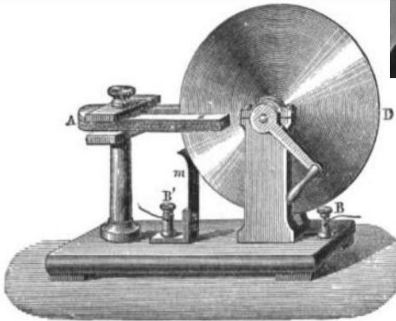
Он также построил первый электромагнитный генератор, названный «диском Фарадея», который являлся униполярным генератором, использовавшим медный диск, вращающийся между полюсами подковообразного магнита.
