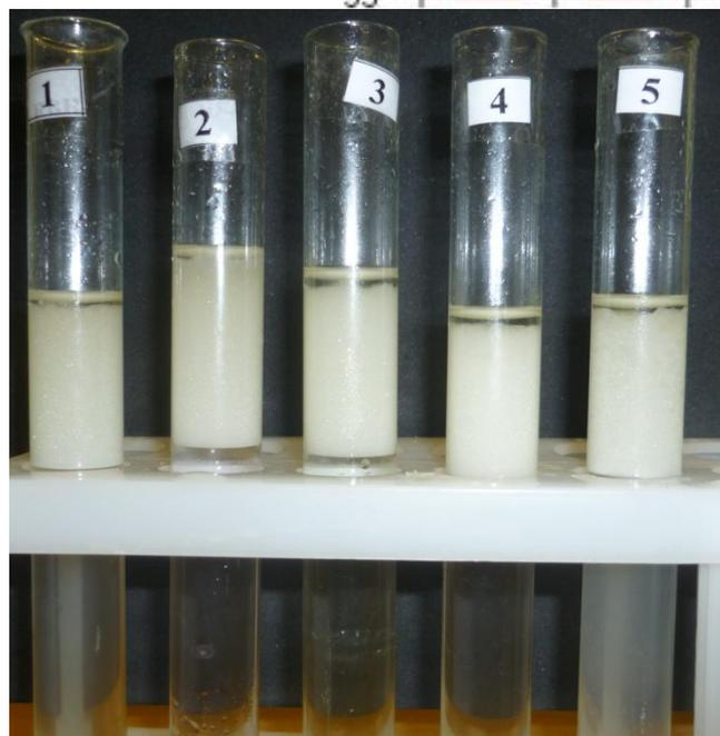
$$\omega = \frac{V_{\text{Эмульсии}}}{V_{\text{Общий}}} \cdot 100\%$$
