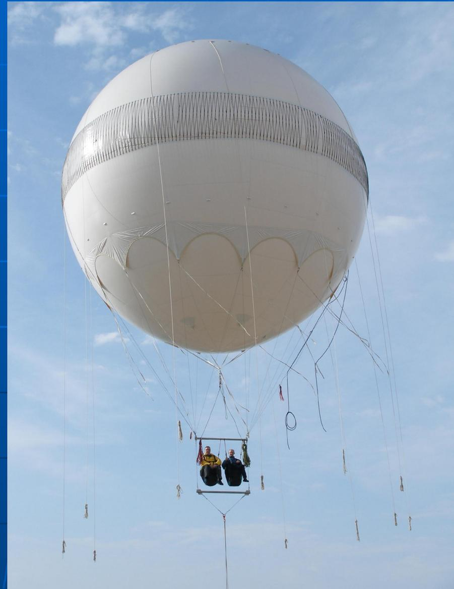
Аттракцион состоит из малообъемного привязного газового аэростата, 2-местной парашютной подвески и лебедки, которая установлена на специальной площадке.
