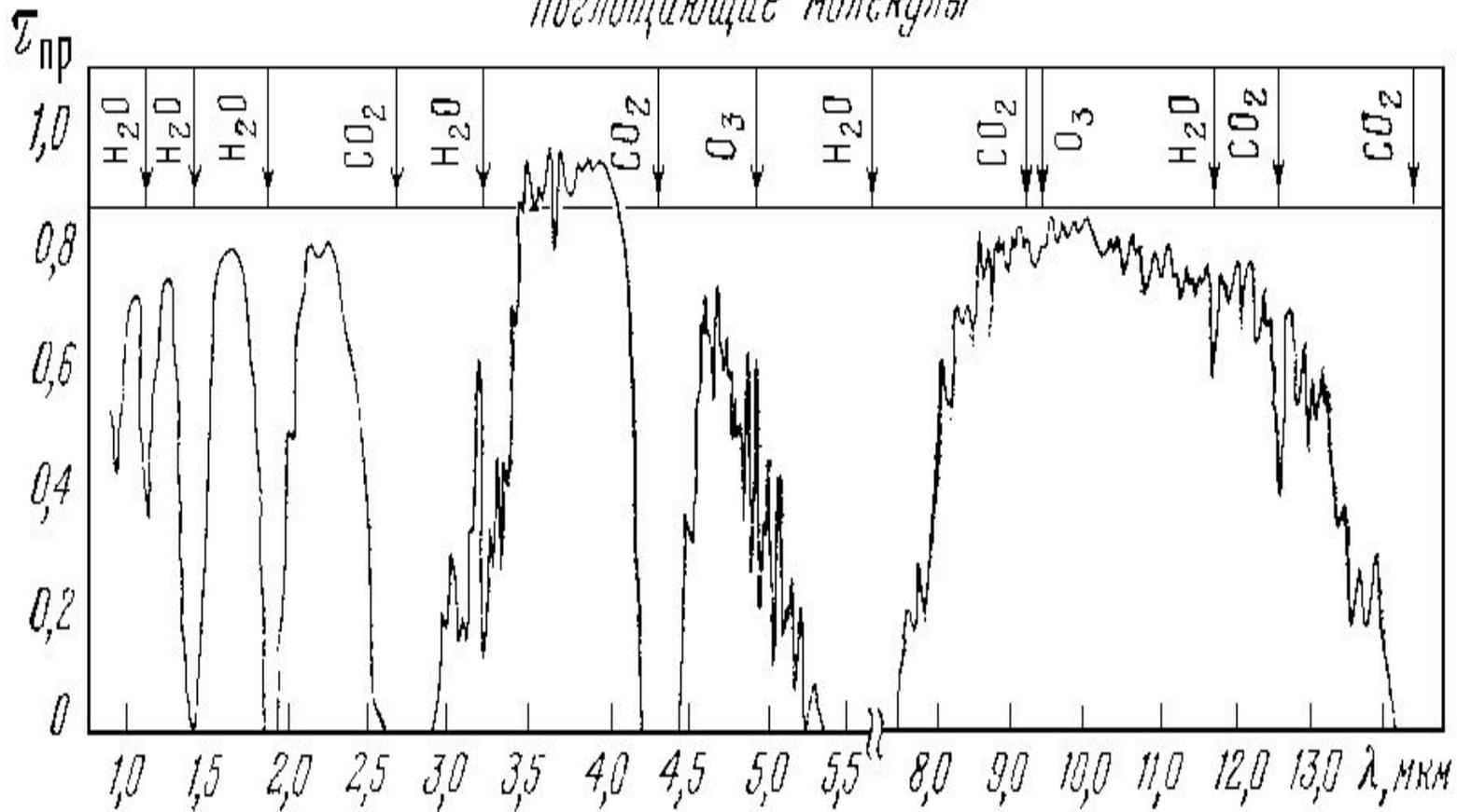
Рис. 1. Спектральное пропускание ИК-излучения атмосферой
