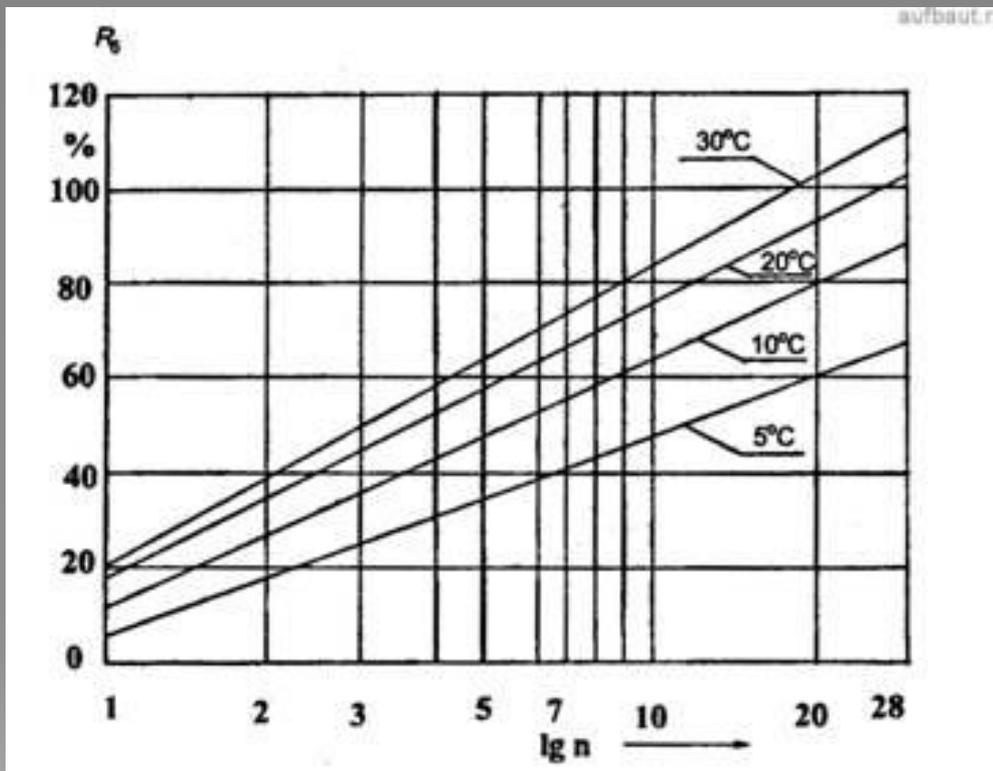
Как видно из графика, прочность бетона в 28-суточном возрасте, твердевшего При 5 °С, составила 68%, при 10°С — 85%, при 30 °С — 115% от предела прочности бетона, твердевшего при температуре 20 °С.
