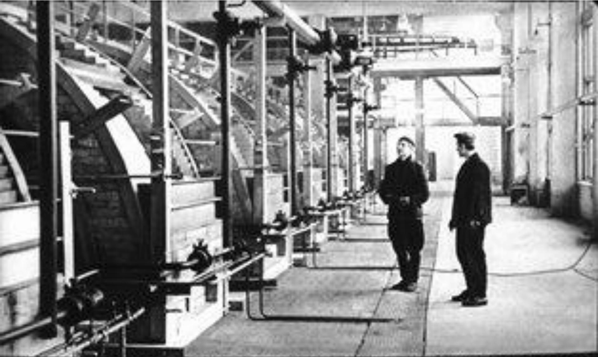
Теперь стекло делают на огромных заводах. Промытый песок просушивается, просеивается и вместе с содой и известью загружается в электрические печи. Всю эту работу выполняют машины.
