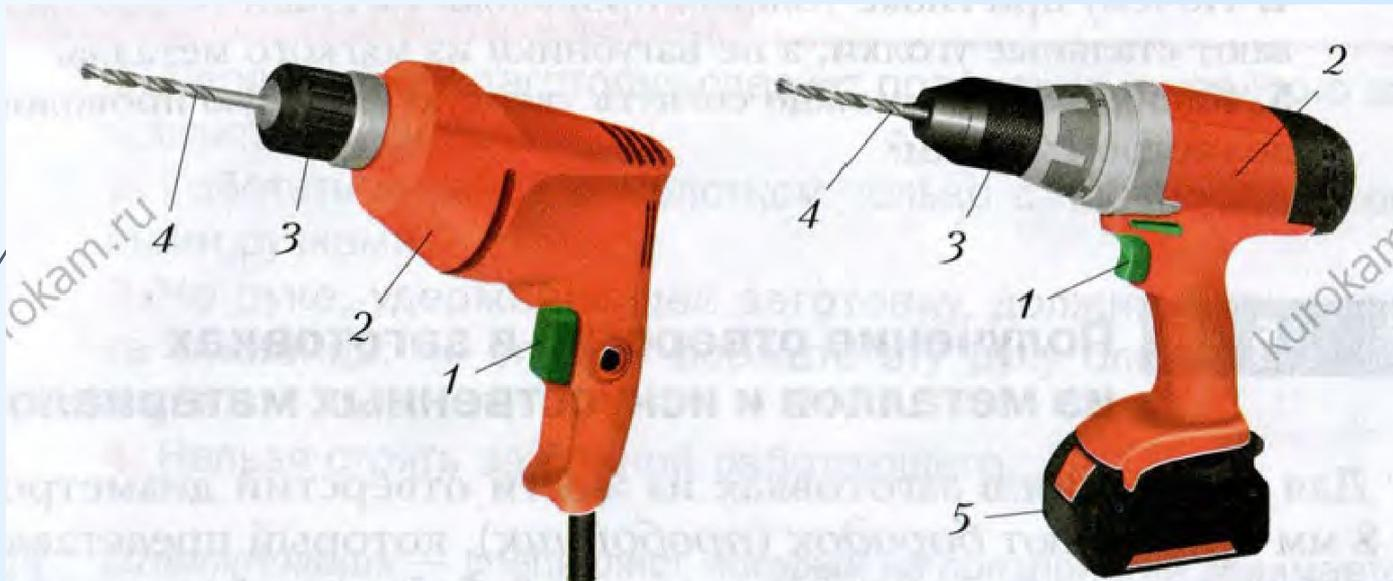
1 – кнопка включения; 2 – электродвигатель в корпусе;
