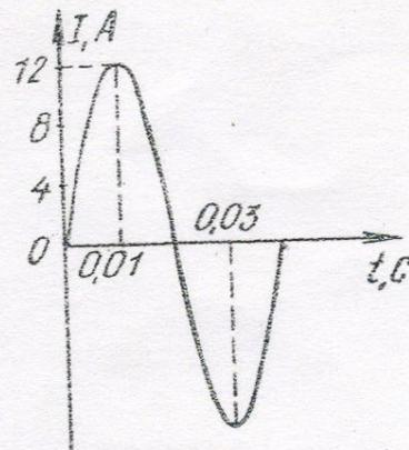
105Т4. По графику, изображенному на рисунке, определите амплитуду силы тока, частоту и значение силы тока для фазы  $\frac{3}{2}\pi$  рад.
