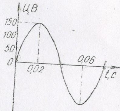
105Т3. По графику, изображенному на рисунке, определите амплитуду силы тока, период и частоту. Напишите уравнение мгновенного значения силы переменного тока.
